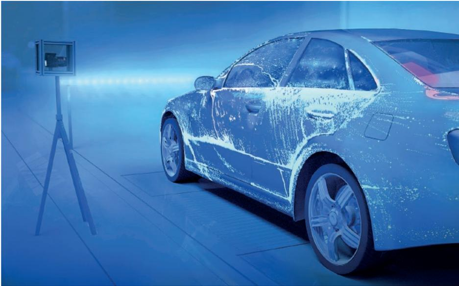
Mit Schmutzfreihaltungstests werden die Auswirkungen von Regen- und Schmutzwasser an Fahrzeugscheiben und Rückspiegeln untersucht und durch geeignete Maßnahmen optimiert. Der Prüfstand muss hierzu mit einer Sprüheinrichtung für ein Gemisch von Wasser und UV-Kontrastmittel und einer geeigneten UV-Beleuchtung ausgerüstet sein.
