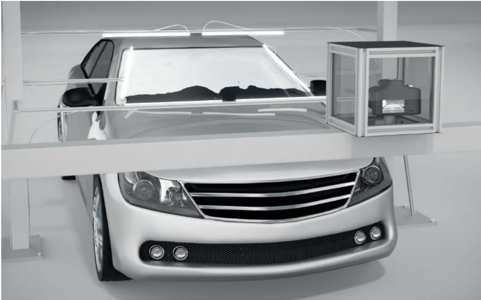
Zur Untersuchung des Auftauverhaltens von Fahrzeugscheiben werden Scheibenenteisungstests in Klimawindkanälen oder geeigneten Klimakammern durchgeführt. Zur effizienten und reproduzierbaren Durchführung dieser Tests bietet **tww systems** ein erprobtes Messsystem an.
